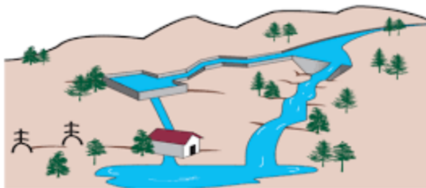
Central hidroelèctrica de tipus floyent. Fuente: IDAE
